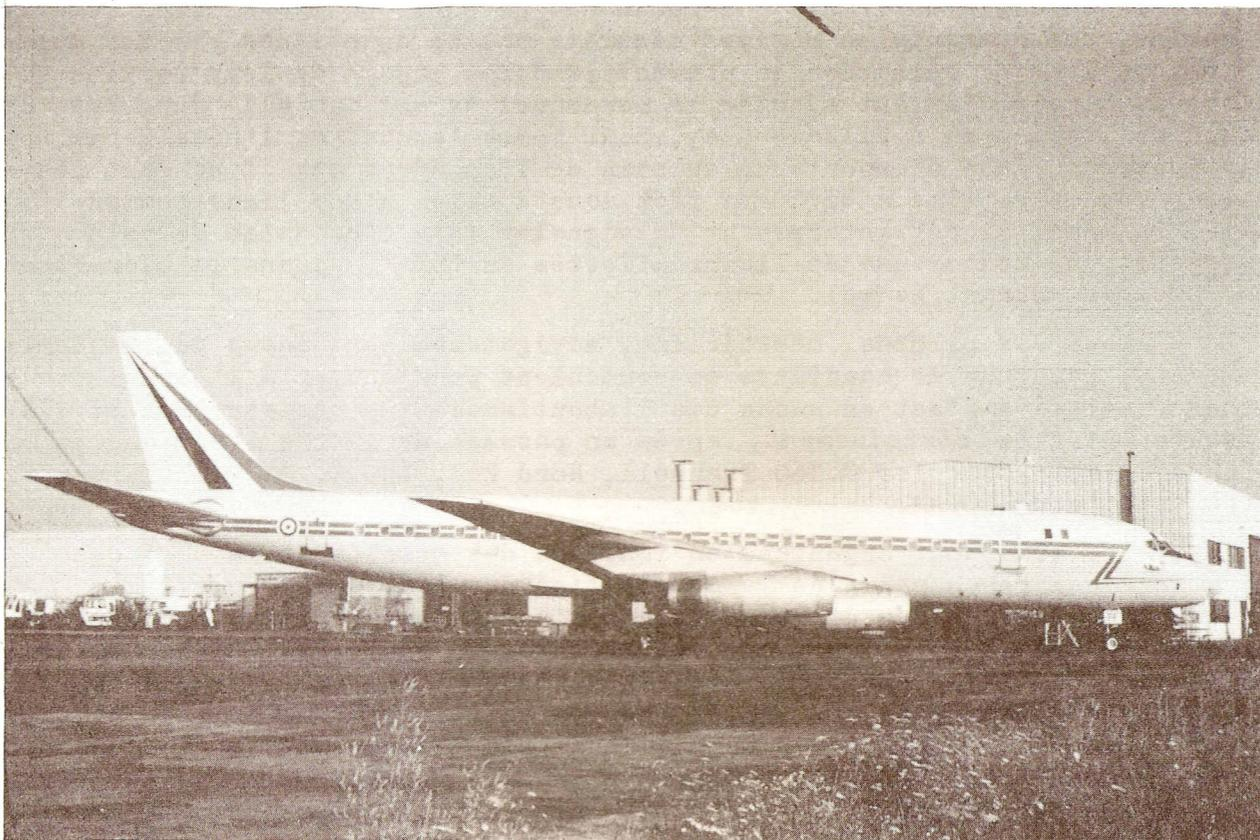
Vu et photographié au Bourget en juillet 1983 par Jacques Guillem, le DC-8-62CF c/n 46130 F-RAFF va bientôt troquer ses vieux réacteurs P&W JT3D-3B pour quatre nouveaux CFM 56-2.
